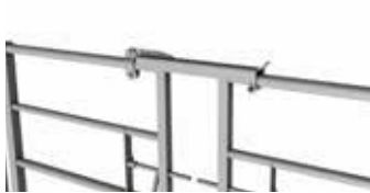
Överliggare för låsning av två grindar eller boxväggar mot varandra. Monteras på Ø42, Ø49 eller Ø60 mm rör med klammer.
