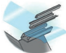
Richel clips att fästa presenningen med och hålla den spänd och tät.
